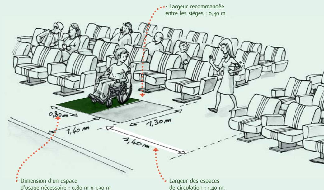
• Dimension d'un espace d'usage nécessaire : 0,80 m x 1,30 m
